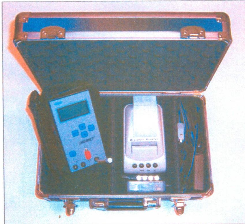
**Medidor Multifuncional de Pulsación/Vacío con capacidades Computacionales de carga e impresión.**
